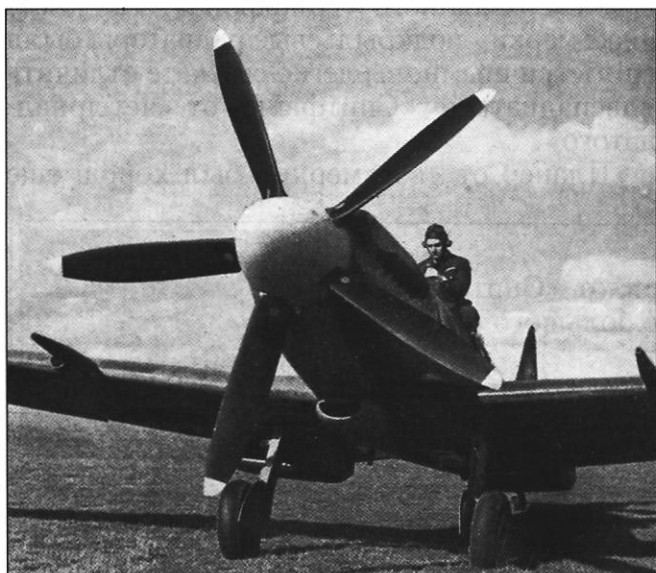
Пятилопастный винт позволял эффективно использовать мощность «Гриффона»
