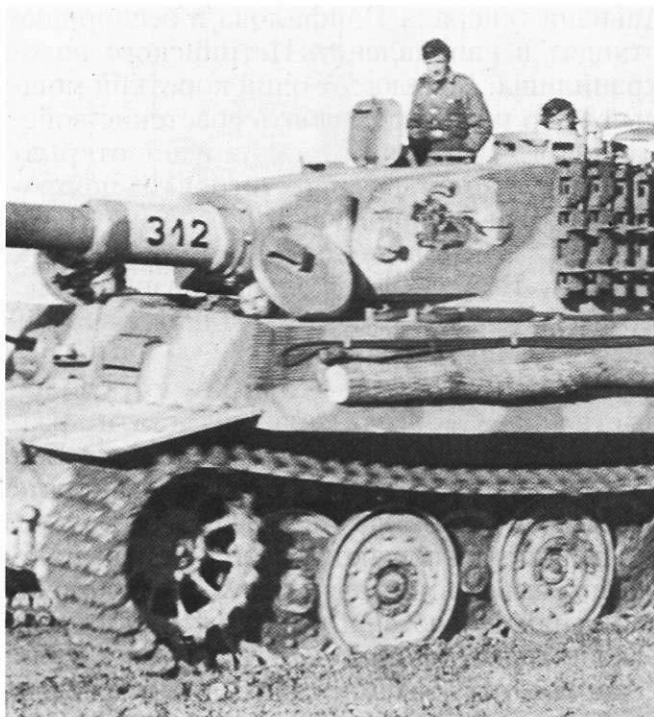
"Тигр" движется по проселочной дороге. Обратите внимание, что внешние катки демонтированы и на танк надеты узкие транспортные гусеницы. Из-за этого он буквально "вспахивает" грунт
