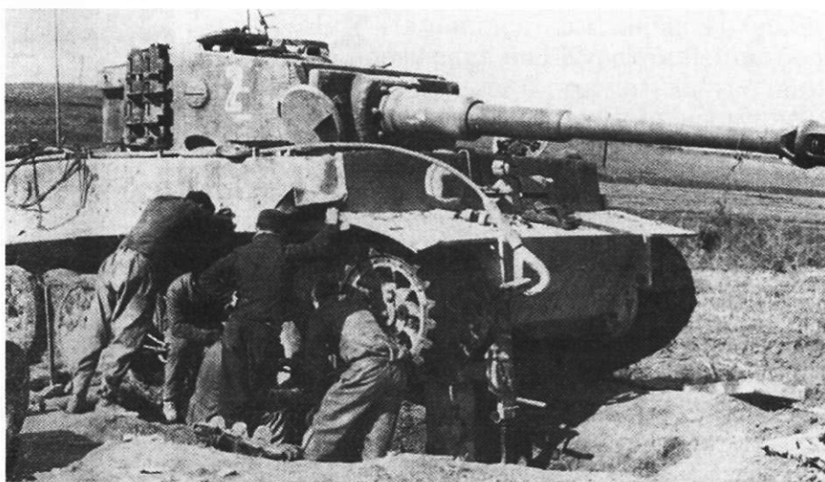
Экипаж ремонтирует "Тигр", подорвавшийся на противотанковой мине. Эпизод сражения на Курской дуге
